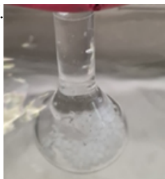
Figura 3. Solución de PCL en ultrasónico (Elaboración propia).
