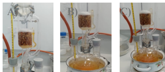
Figura 2. A) Solución de etanol-capsaicina en el primer ciclo de extracción. B) Octavo ciclo. C) Doceavo ciclo.
